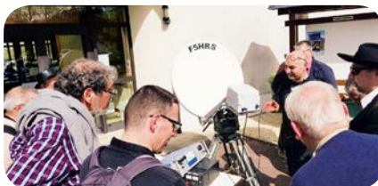
F5HRS présente son banc de réglage de source 10 GHz sur le soleil
