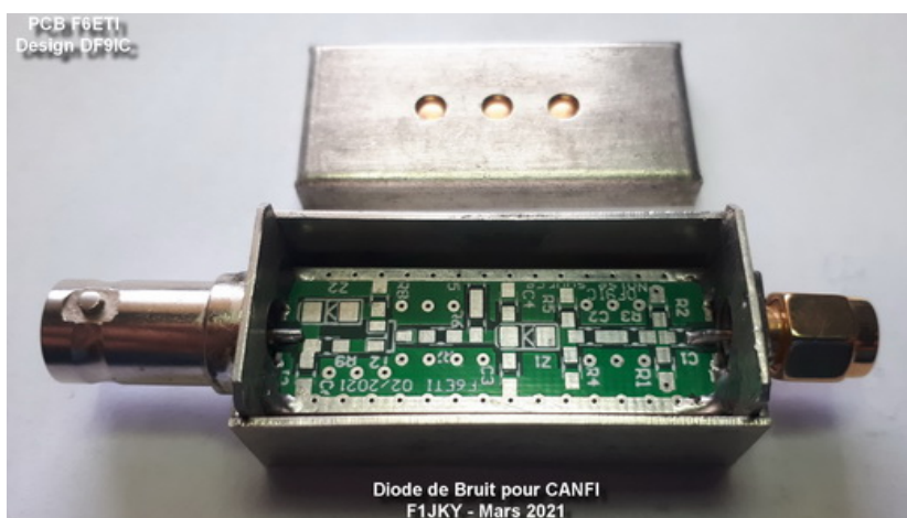
Le PCB + les fiches montés et soudés dans le boîtier
