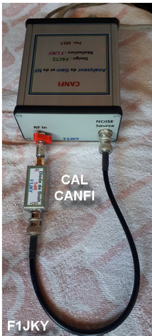
Calibration du CANFI avant la mesure du LNA, avec la Diode de Bruit et son atténuateur de 6dB
