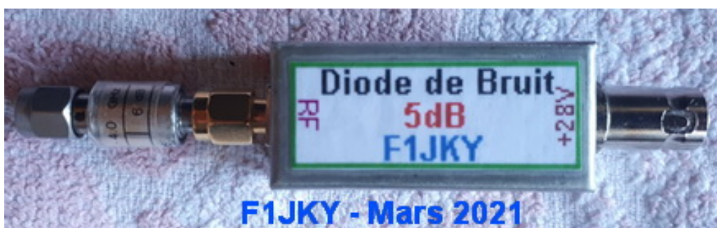
La Diode de Bruit finie avec son Atténuateur de 6dB / 4GHz
