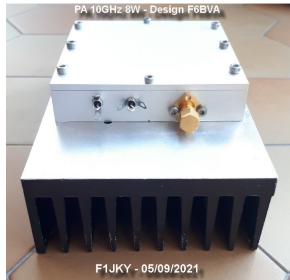
PA monté sur son refroidisseur en Aluminium
