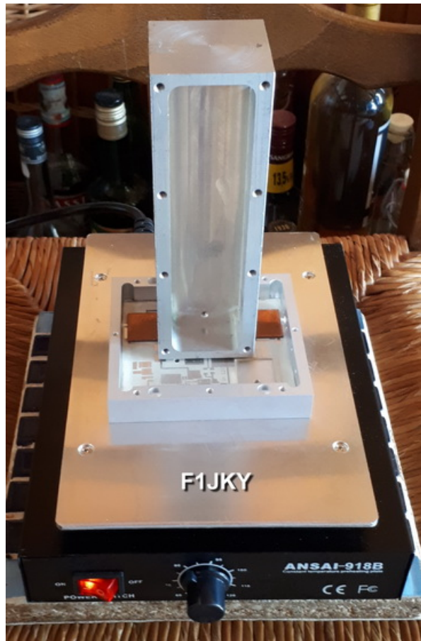
Collage PCB avec Plaque Chauffante 80°C
