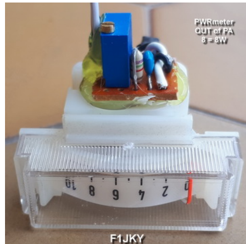
Vumètre avec son électronique de réglage
