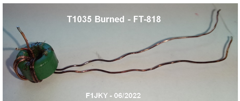
Après Démontage, on constate que le vernis du fil émaillé à brûlé
